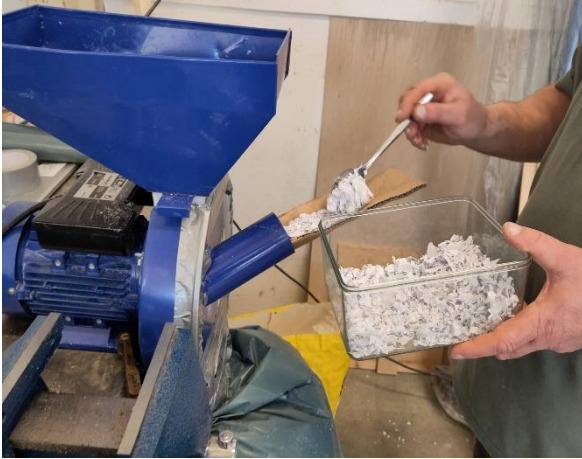
Figuur 6 Materialen verkleinen is een essentiële stap in de productie van biobased materialen.
