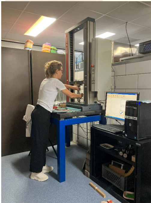
Figuur 10 Via Krimppp wordt onderzoek gedaan aan de trekbank van partner PaperFoam.
